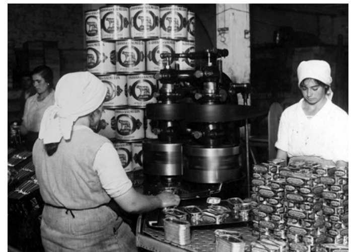
Arquivo da familia Attilio Gaggero. Cadea de traballo nas máquinas pechadoras de latas da fábrica Attilio Gaggero de Bueu, cara a 1970.
