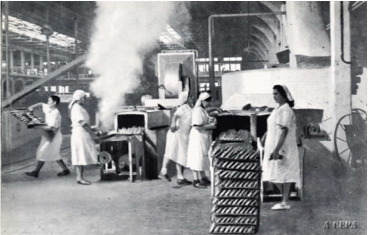
Arquivo da Asociación Cultural A Ceba de Cangas. Sección de cocción da conserveira Massó en Cangas nos fornos de cocción continua, patentados por Massó Hermanos, S. A., cara a 1970.
