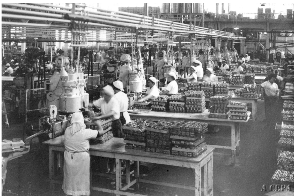
Massó. Proceso de pechado de latas a máquina, Cangas (Pontevedra), s.d
